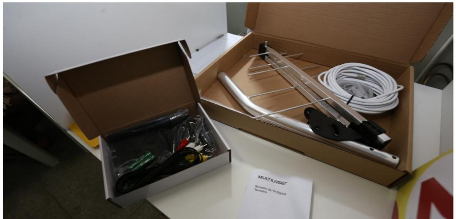
O kit é composto por uma antena receptora sinal UHF, cabos e um aparelho conversor digital
