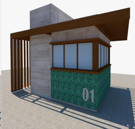
O projeto vai além da parte estética. Pensando na qualidade da estrutura, o concreto e as pastilhas cerâmicas, materiais resistentes e de grande durabilidade, serão utilizados para os acabamentos externos dos quiosques.
