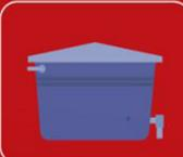
Mantenha a caixa d'água bem fechada. Coloque também uma tela no ladrão da caixa.
